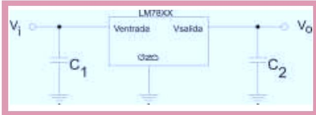
Los **capacitores** actúan de filtro para disminuir el rizado proveniente de la fuente de la alimentación. Pueden evitarse, si la fuente de alimentación está bien diseñada.
