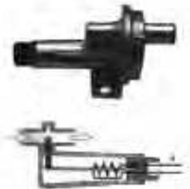
*Actuador de ralenti 2 (válvula de regulación de ralenti):* En algunos equipos de inyección se encuentra este tipo de actuador de ralenti; la válvula de paso de aire puede girar 90° y, de este modo, abre o cierra el conducto *by-pass*. Pero, para ajustar las revoluciones, se debe lograr mantenerla en posiciones intermedias.
